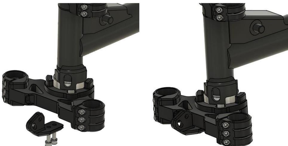
7. Gabelholme Montieren: Zuerst die unteren 6 M6x25 Schrauben mit einem Anzugsdrehmoment von **10Nm** anziehen + Schraubensicherung (Mittelfest).
