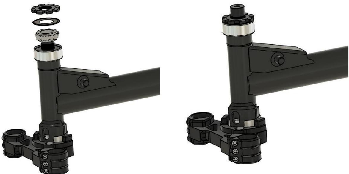
5. Die obere Gabelbrücke kann jetzt mit der Abdeckkappe montiert werden.
