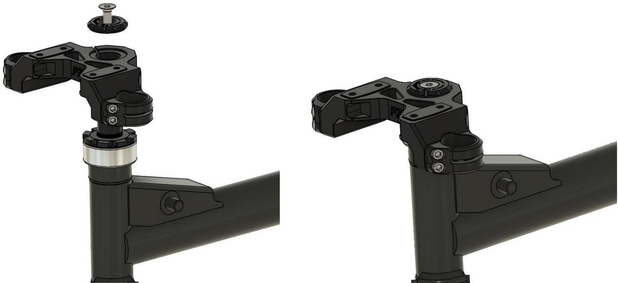
6. Den Lampenhalter verschrauben. M6x20 mit **10Nm+** Schraubensicherung (**Mittelfest**).
