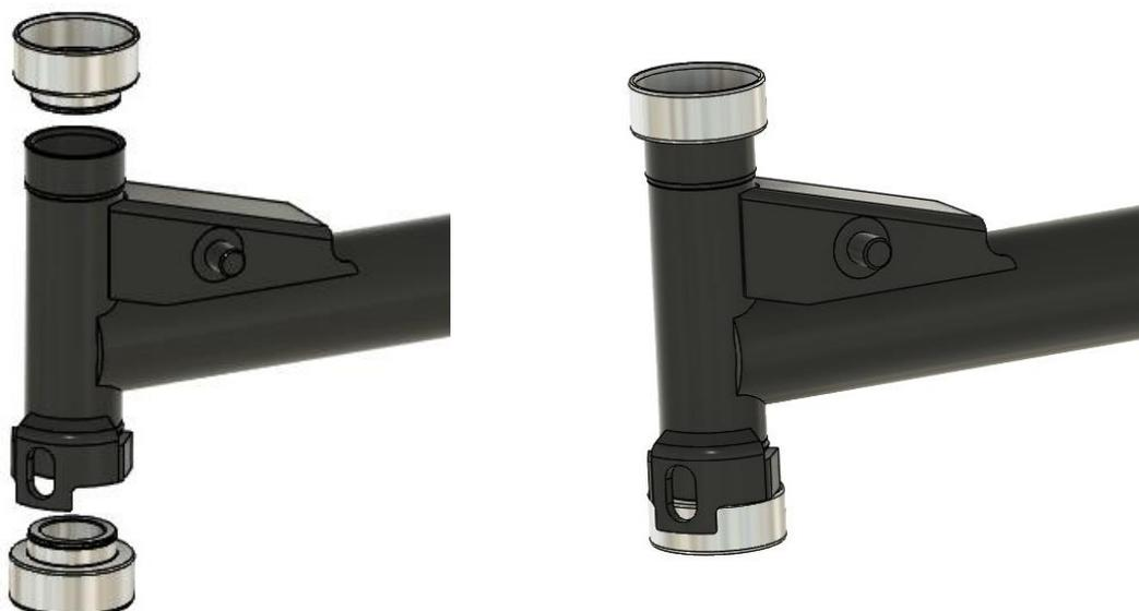
3. Jetzt muss auf das Gabelrohr erst die Staubschutzkappe und dann ein mit handelsüblichen Mehrzweckfett eingefettetes Kegelrollenlager gesteckt und dann von unten durch den Rahmen geschoben werden.
