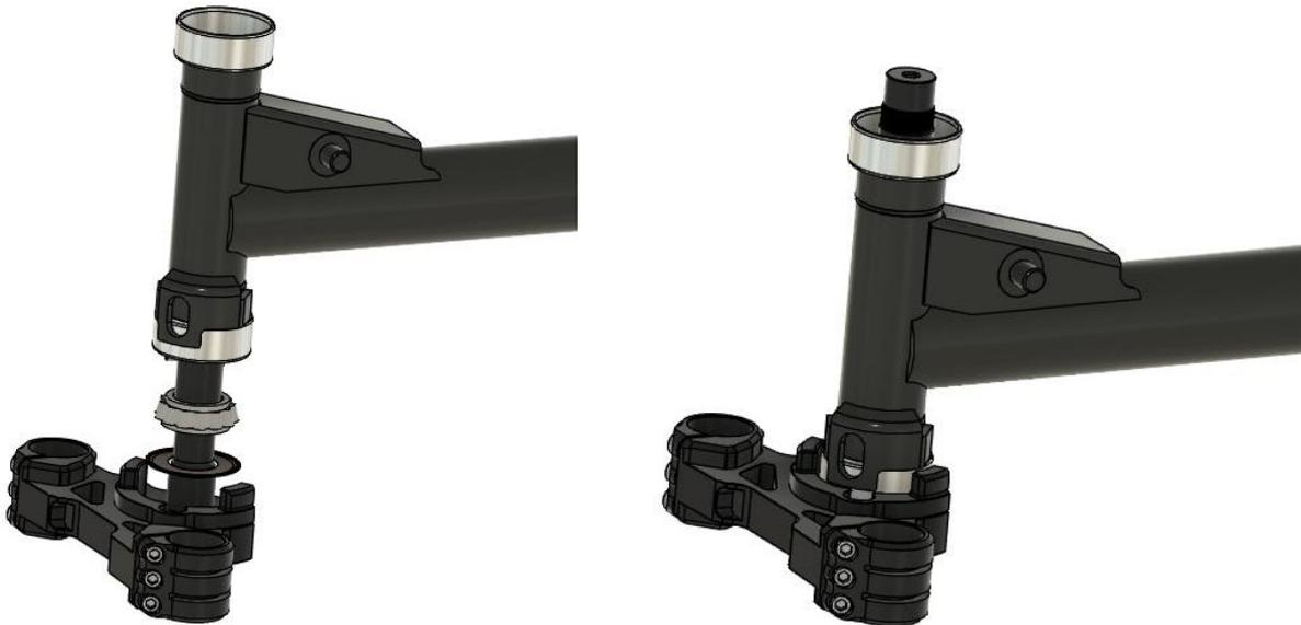
4. Nun wird auch das obere Kegelrollenlager (gefettet mit Mehrzweckfett) und Staubschutzkappe aufgesteckt. Dann kann die Einstellmutter aufgedreht werden. Nun kann das Lenkkopflagerspiel grob voreingestellt werden.
